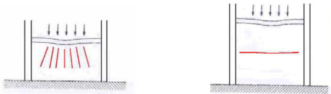
Fig. 3.- Fisuras en tabiques de planta baja (poca altura y esbelto).
